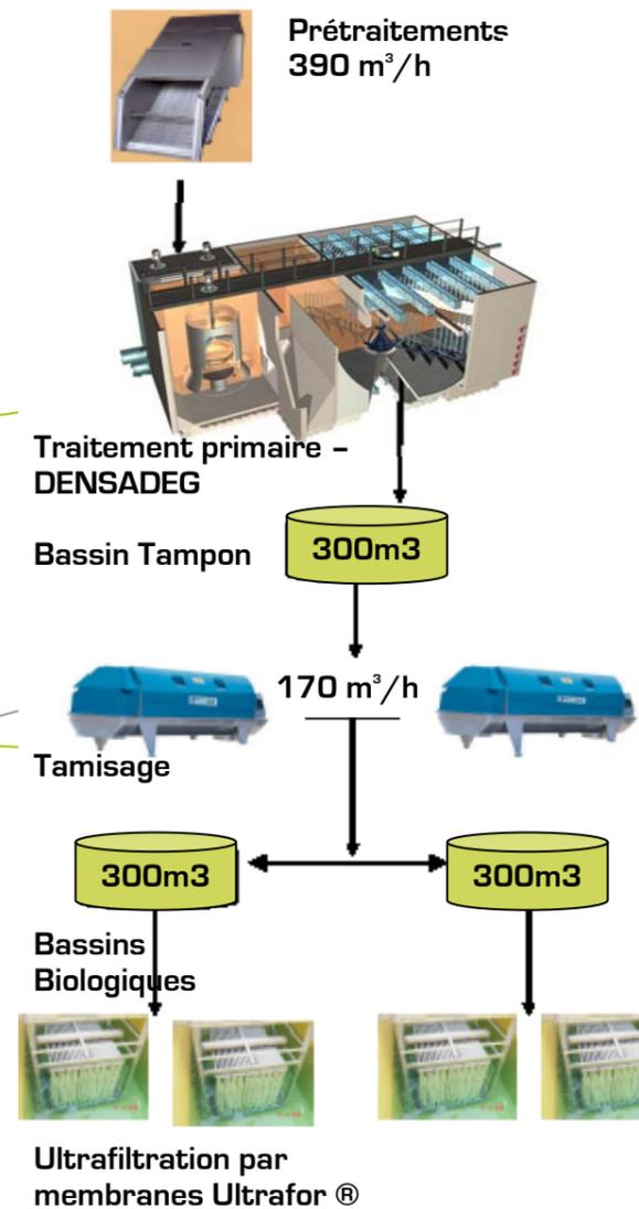
Grâce à la mise en place d'un décanteur primaire lamellaire, suivi de deux lignes de traitements biologiques équipées de la technologie d'ultrafiltration membranaire, l'eau traitée présente une qualité permettant sa ré-utilisation pour l'arrosage et notamment celui du Golf de SPERONE.
